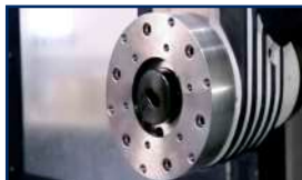
Montar la placa de acoplamiento.
