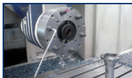
Montar el cono ISO en la máquina.
