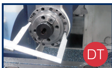
Medir cota DT de cabezal.
