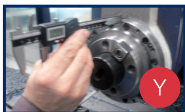
Medir profundidad del cabezal.
