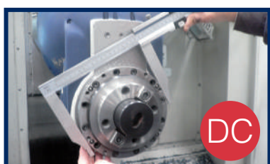
Medir cota DC de cabezal.
